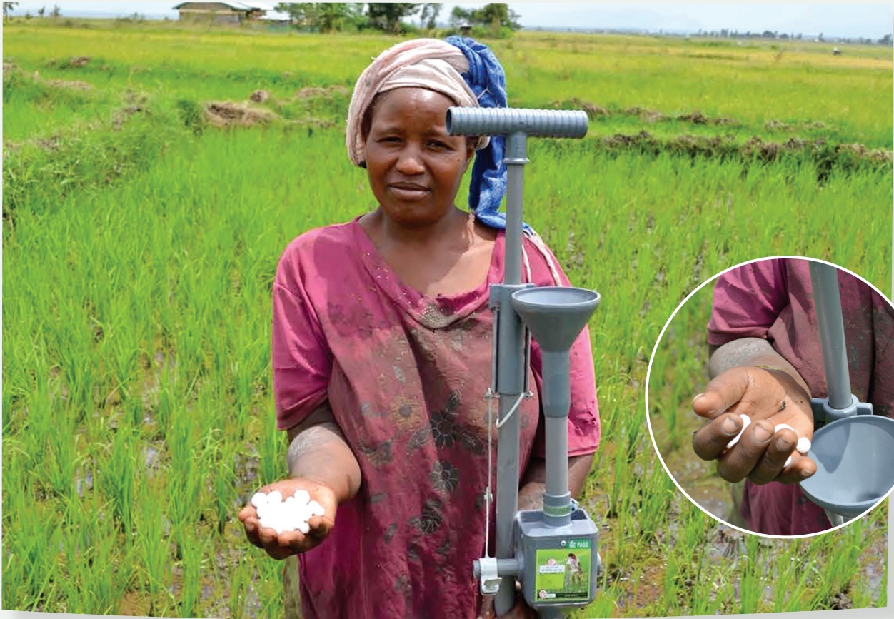
አርሶ አደር የተጨመቁ የዩሪያ እንክብሎችንና በረግረግ ማሳ ለተመረተ ፍብ በጥልቀት የሚጨመርበትን መሳሪያ ይዞ
